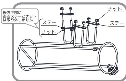
①ポンベ架にステーとナットが仮組みされていますので、分解します。
