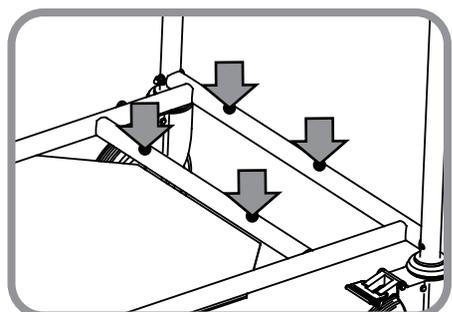
③一度ポンベ架を外し、②でつけた印の位置に、上からドリル (3.5mm) で穴をあけます。(4箇所)
