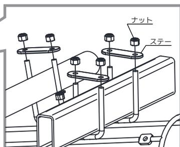
⑤対辺 10mm スパナで、ナットを締結します。この際、ポンベ架が少し動く程度に締結してください。
