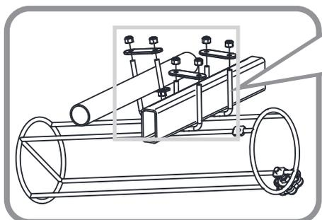
④①で取り外したステーを挿入し、ナットを仮締めます。
