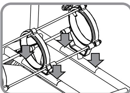
④③であけた穴にあわせてポンベ架をあてがい、同梱のビス (4.5mm) でポンベ架を固定します。(4箇所)
