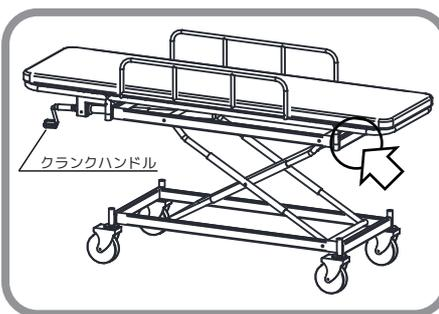
②ポンベ架は、クランクハンドルとは反対側の、上部フレームに向かって左側に固定します。
