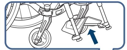
③ 角度を調整し、六角レンチを用いて、ボルトをしめる。
