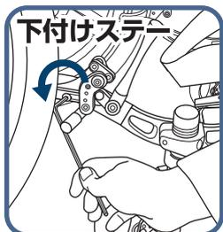
② ブレーキを解除した状態で、ブレーキシユウと車輪の間隔が約10mmのところ、ボルトを固定する。
