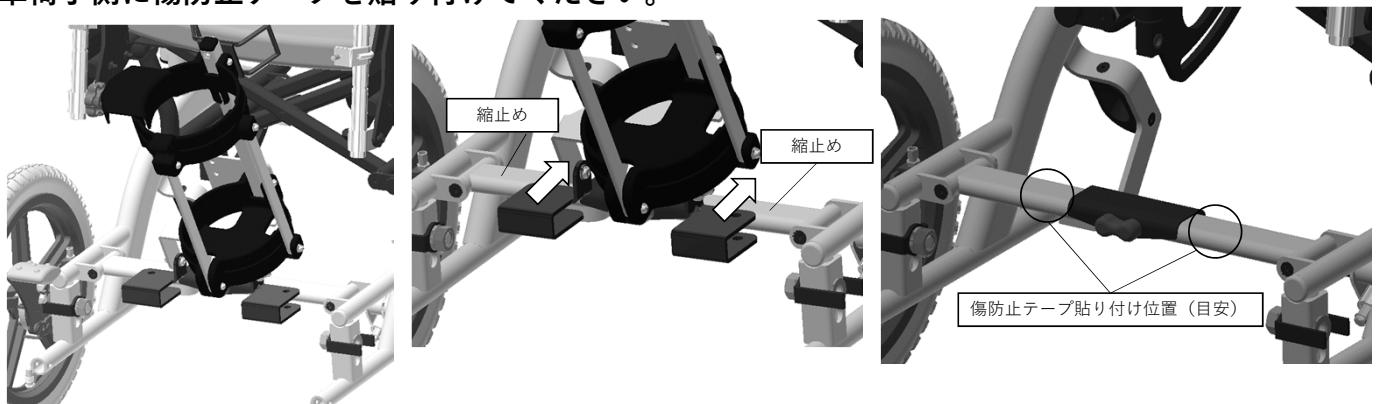
車椅子側の縮止めにボンベ架の取付け金具を図のように合わせ、その位置に傷防止テープをパイプ側に貼り付けて下さい。
