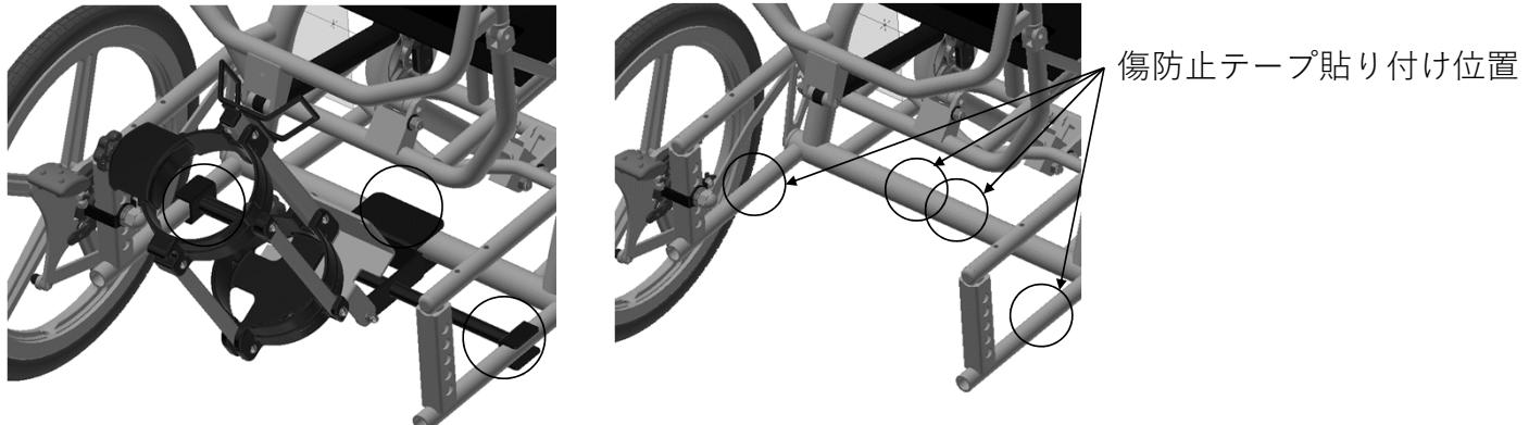
フレームにボンベ架の取付け金具を図のように合わせ、その位置に傷防止テープをパイプ側に貼り付けて下さい。
