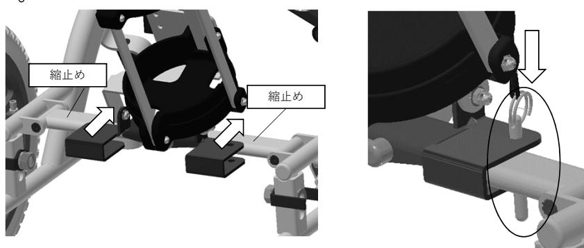
ボンベ架の取付け金具を、縮止めに挟むようにしっかりと奥まで差し込みます。
