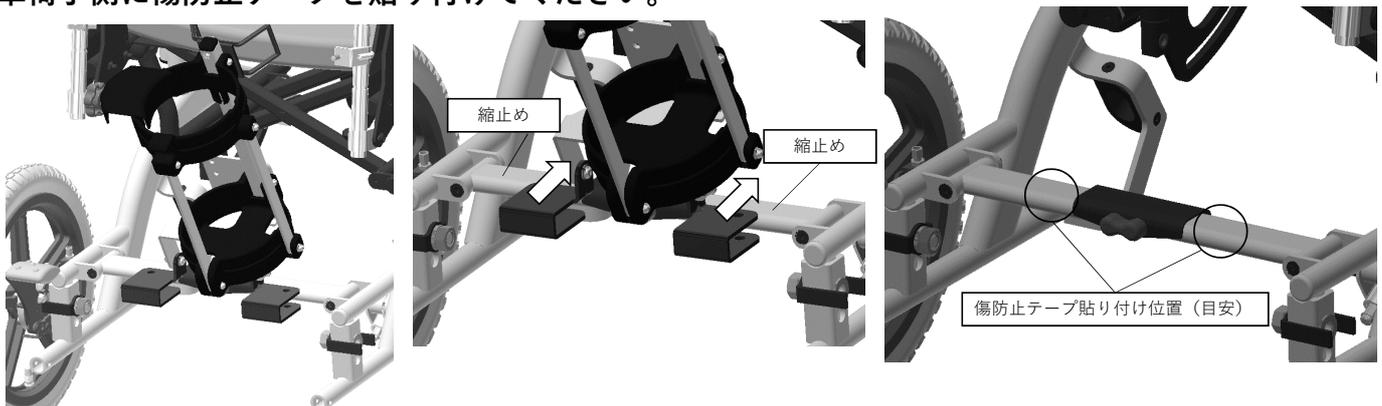
車椅子側の縮止めにポンベ架の取付け金具を図のように合わせ、その位置に傷防止テープをパイプ側に貼り付けて下さい。
