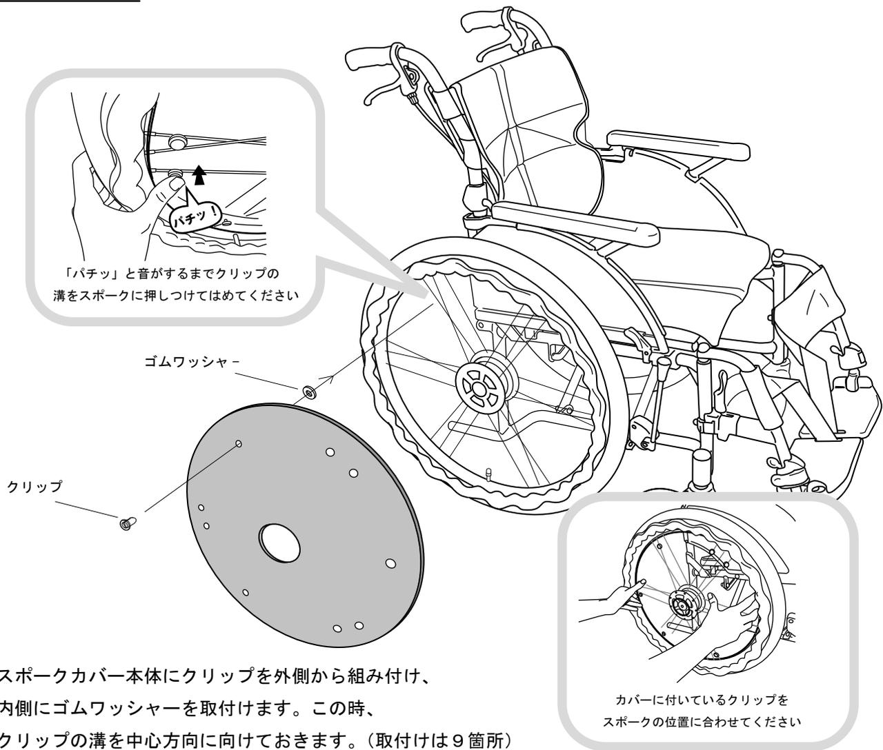
スポークカバー本体にクリップを外側から組み付け、内側にゴムワッシャーを取付けます。この時、クリップの溝を中心方向に向けておきます。(取付けは9箇所)
